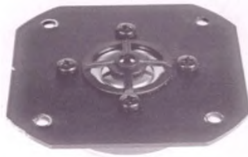
Tweeter classique à dôme et à membrane en titane. Le DTW 86 FFL reproduit ici les fréquences supérieures à 3 200 Hz.
