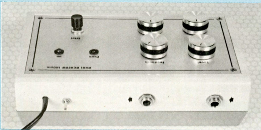
Raccordement de la réverbération par prises jack 6,35 mm.
