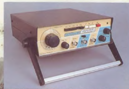
Générateur de fonctions 368 1 Hz à 200 KHz
