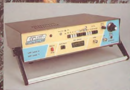
Générateur de mire PAL/SECAM 689 VHF bande III - UHF bande IV Standard B, G, L, L'. En option : K'
