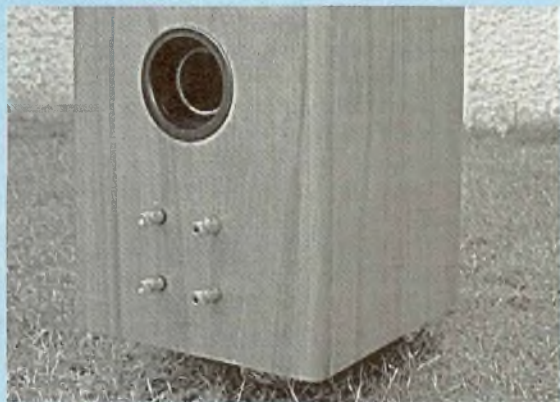
Une partie de Cristal Sept vue de l'arrière (évent et borniers)
