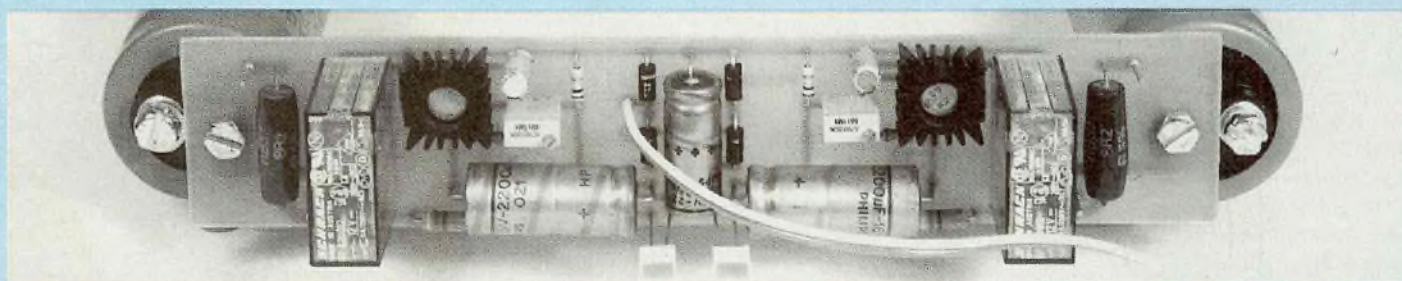
Le module de temporisation est maintenu en place dans le coffret ESM par les condensateurs de liaisons des amplificateurs (C6 - 4 700 \mu F/63 V).
