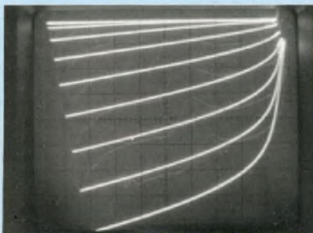
14. 2N3820 (FET canal P) avec 0,2 \text{ V}/\text{éch.} et R_D = 2 \text{ k}\Omega [Y : 0,2 \text{ V}/\text{div.} et X : 2 \text{ V}/\text{div.} ].
