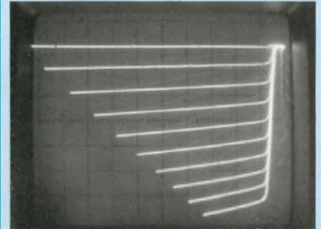
12. Faux Darlington PNP réalisé avec le 2N2907 et le 2N3055 (fig. 11) 5 \mu\text{A}/\text{éch.} et R_c = 20 \Omega . [Y : 1 \text{ V}/\text{div.} et X : 2 \text{ V}/\text{div.} ].
