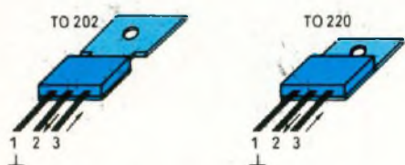
Les flèches indiquent le sens de passage du courant dans le régulateur
