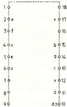
Afficheur 20,3mm x anode ou cathode commune (vue de dessus)
