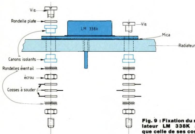
Fig. 9 : Fixation du régulateur LM 338K ainsi que celle de ses cosses.
