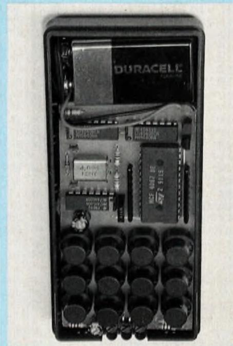
férer le programme dans le  $\mu$ Contrôleur à l'aide du montage proposé dans le Led n°97. Si la programmation est correcte, la diode "programmé" s'illumine au bout d'un certain temps (2 s à 1 mn 40 selon le nombre de bits à 1) suivie 2 secondes plus tard par la diode "vérifié". Le  $\mu$ Contrôleur n'a plus qu'à être installé sur le récepteur.
