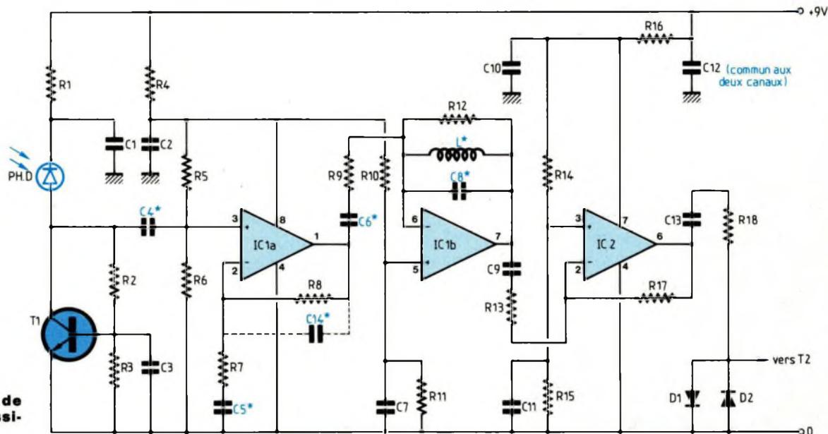
Fig. 11 : Circuits de préamplification dessinés pour une voie.
