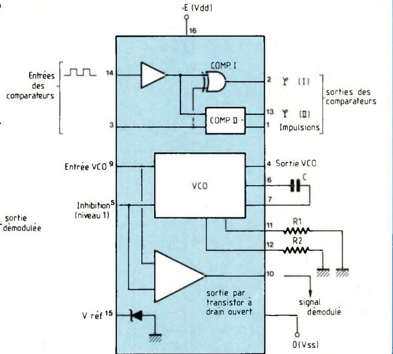
**Fig. 15 : Utilisation du CD 4046 pour la démodulation de fréquence.**
