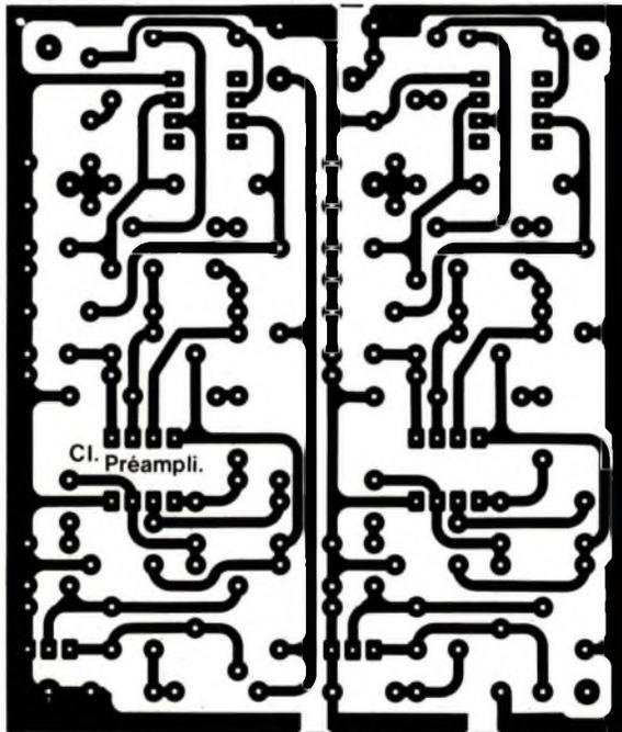
Fig. 20 : Circuit imprimé des préamplificateurs.
