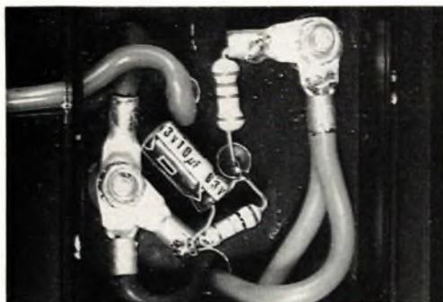
Fig. 10 : Câblage "en l'air" des composants.
