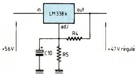
Fig. 5 : Une régulation à base de LM 338K.
