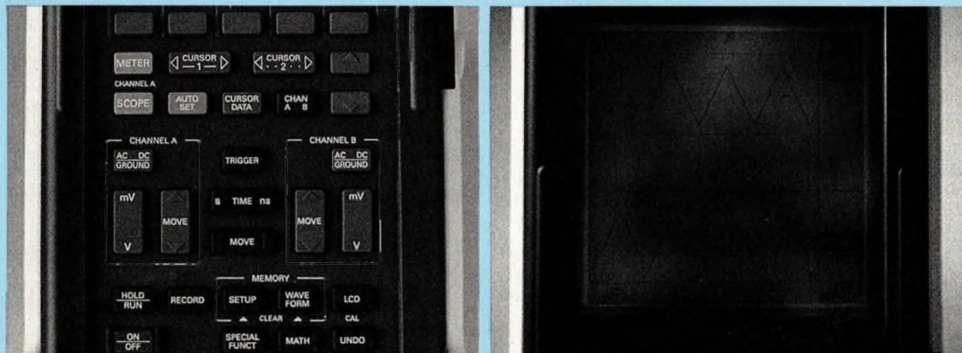
Photo I : Toutes les commandes, centralisées en façade, s'effectuent à l'aide de poussoirs, soit directement (sensibilité, vitesse de balayage, mode de couplage des entrées, etc.), soit à travers des menus qui s'affichent à l'écran. Photo III : Aspect de l'écran, avec mise en service de l'éclairage électroluminescent (les reflets sont provoqués par l'éclairage ambiant de la pièce).
