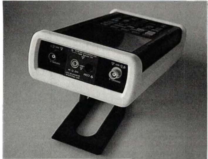
Photo II : Le sommet du scopemètre regroupe les diverses entrées, et les sorties de générateurs internes.
