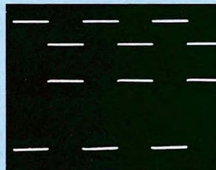
7. Signal carré à 100 Hz (amplitude 30 V c. à c.).
