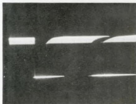
Signal prélevé aux bornes d'une charge résistive de 8 \Omega . On observe bien le glissement de la fréquence (crêteau négatif) qui donne ce son modulé à "l'américaine".
