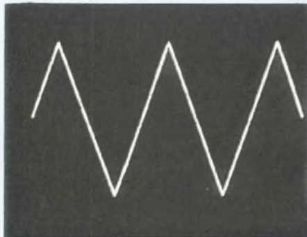
Signal triangulaire de fréquence 1 kHz.
