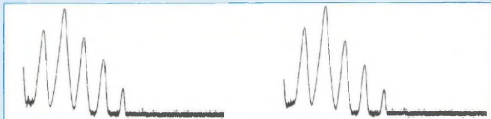
Fig. 3 : Les deux spectres de distortion pour V_{out} = 3V (à gauche avec l'atténuateur, à droite avec le filtre).
