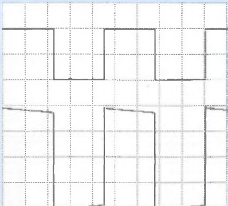
2 : Signal carré à 40 Hz à une puissance de 50 Welf.
