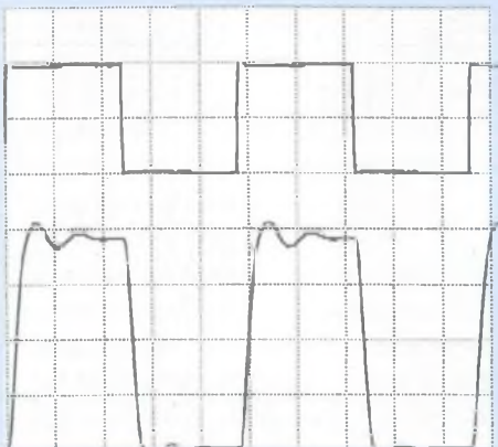
4 : Signal carré à 10 kHz à une puissance de 50 Welf. Le temps de montée est de 4,5 \mu s. La cellule de rétroaction est ici de 2,2 k \Omega /1 nF.
