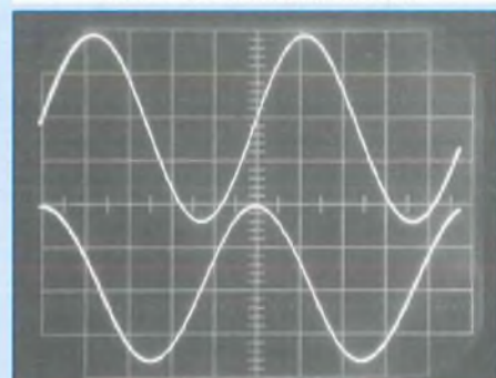
Photo 2 : entrée venant du GBF proposé (trace supérieure) : 5 V/cm ; sortie : 0,5 V/cm ; 0,2 ms/cm
