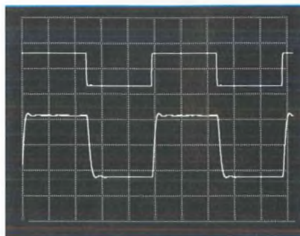
Signal carré à 10 kHz. Le temps de montée est de 2,5 µs.
