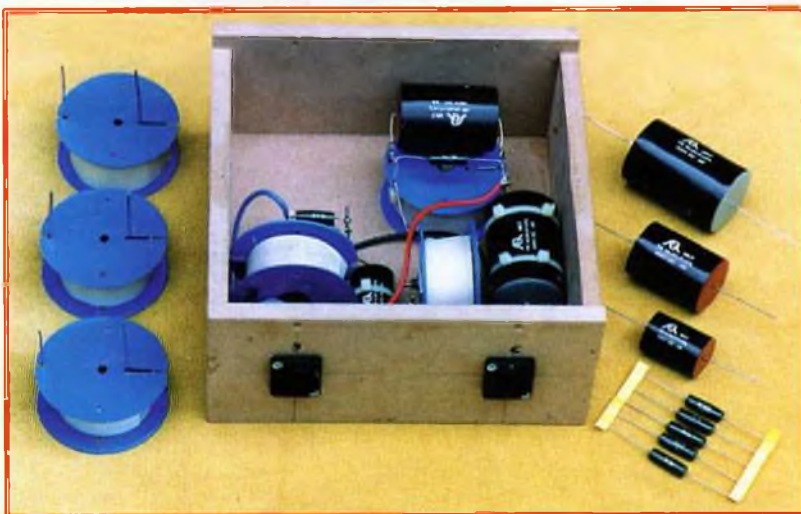
ENSEMBLE DES COMPOSANTS DU FILTRE PASSIF 2 VOIES Selfs. CONDENSATEURS. RÉSISTANCES. PRISES SPEAKON MÂLE / FEMELLE
