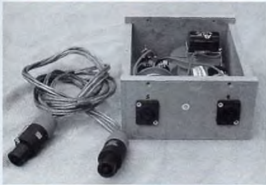
Photo 7 : le filtre avec le câble d'interconnexions
