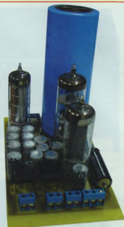
Le module alimentation stabilisée.
