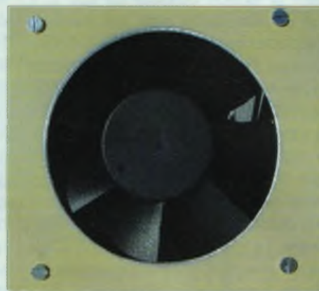
Figure 5 : le ventilateur est fixé dans la plaque de fond.
