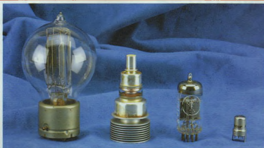
Figure 4 : de gauche à droite : Triode 216B Western Electric (collection Balaton, 1922). Triode phare 2C41 : ce tube peut amplifier des fréquences jusqu'à 4 000 MHz ! (1942). Triode ECC83 très utilisée en audio. Triode céramique 6CW4 dite «Nuvistor» (1963) : le tube fétiche des pré-amplificateurs Conrad-Johnson.
