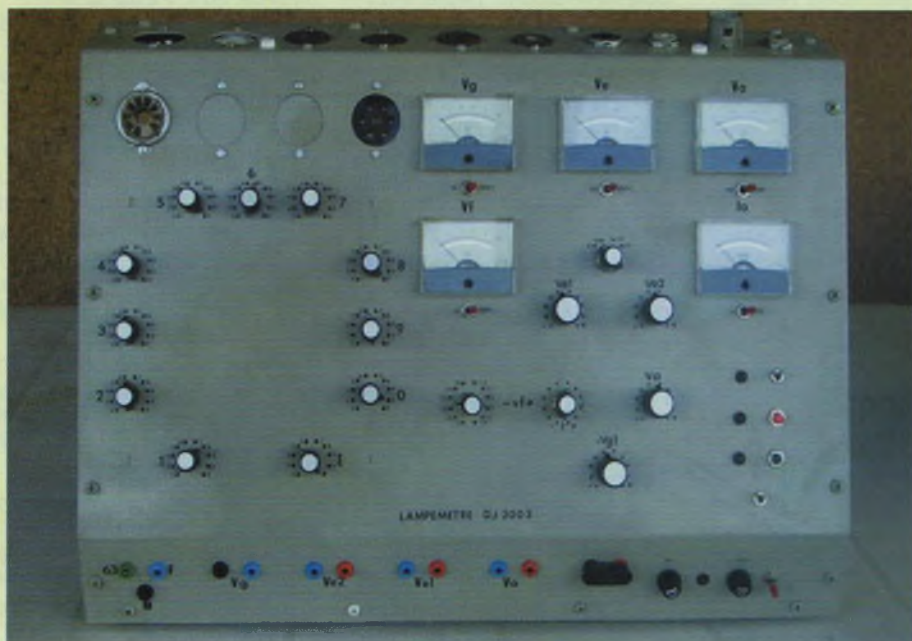
Figure 1 : Façade du lampemètre DJ 2003.
