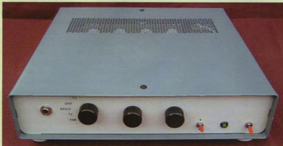
Ce préamplificateur a été conçu pour former avec l'amplificateur Push-Pull (LED n° 179) un ensemble complémentaire qui se devait d'être à la hauteur des performances de ce dernier. Il permet la sélection de cinq sources, possède une sortie enregistrement, une sortie 1V<sub>eff</sub> à basse impédance et une sortie pour casque.
