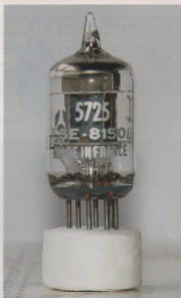
Photo B : Le tube 5725 est une pentode à grille cadre de la dernière génération
