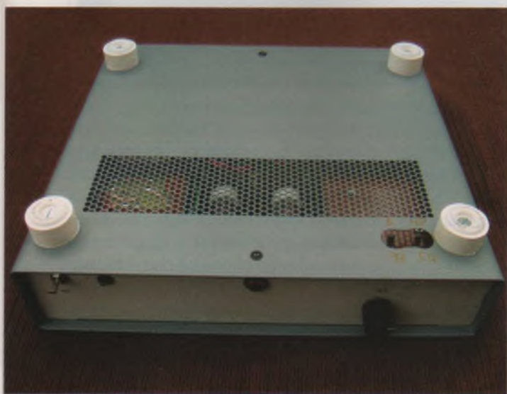
Photos 3 et 4 : Les commutateurs d'impédance sont accessibles sous l'amplificateur (une découpe est pratiquée dans le capot inférieur)
