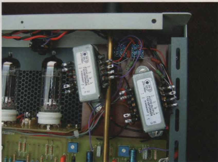
Photo 2 : Vue sur les transformateurs de sortie et les tubes de puissance ECC99
