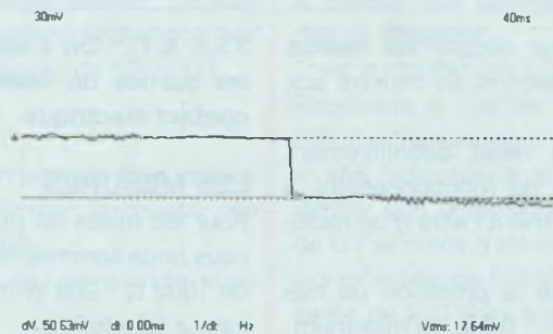
Figure 24 : Variation de tension pour un échelon positif de 100 mA
