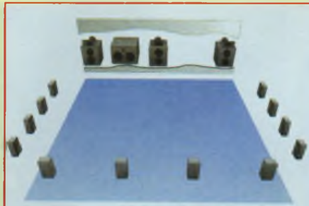
Figure 1 : Disposition classique des haut-parleurs dans une salle de cinéma. Les enceintes situées à l'arrière sont dorénavant indépendantes des canaux « surround gauche et droite » et pilotées par une matrice additive « dolby ». C'est le sixième canal du système 5 + 1 (voir texte)
