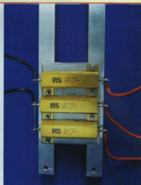
Photo 17 : Les trois résistances de charges de 22 kΩ/50 W
