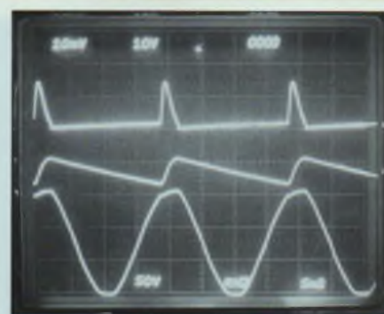
Figure 3 : Oscillogramme correspondant au schéma de la figure 1 (simple alternance). Condensateur C : 20 \mu\text{F} . R charge : 6,8 \text{ k}\Omega . U_c = 70 \text{ V} . Ondulation \approx 7 \text{ V} (10 %). Courant dans la charge : 70/6800 = 10,2 \text{ mA} . Courant impulsif : 140 \text{ mA} . (Echelle du courant en haut : 100 \text{ mA}/\text{carreau} ).
