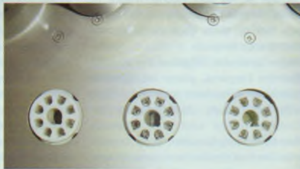
Photo J (ci-contre) : Positionnement des supports OCTAL par rapport à la face avant. Les détrompeurs forment un angle de 135°
