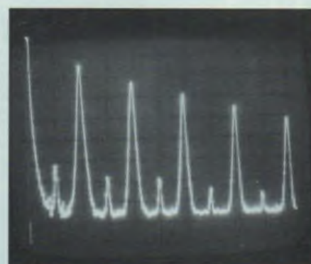
Figure 6 : Spectre de la tension redressée à 100 Hz
