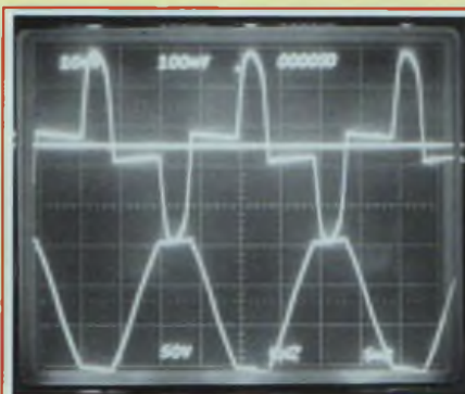
Figure 7 : En haut, courant pulsé absorbé par le transformateur d'alimentation. Ce courant va circuler partout et rayonner, y compris dans les murs de votre living, jusqu'au compteur ! En bas, tension au secondaire, les méplats sur la sinusoïde correspondent à la saturation du circuit magnétique à chaque impulsion.
