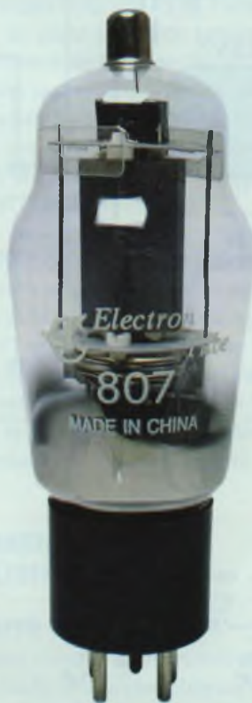
Photo A : Gros bulbe en verre surmonté d'un téton
