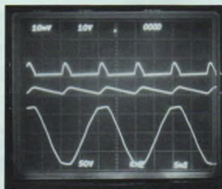
Figure 5 : Filtrage après redressement double alternance. A gauche : condensateur de 20 µF. A droite : condensateur de 330 µF. Courant impulsionnel pour une charge de 10,2 mA. Environ 70 mA avec 20 µF et environ 110 mA avec 330 µF.
