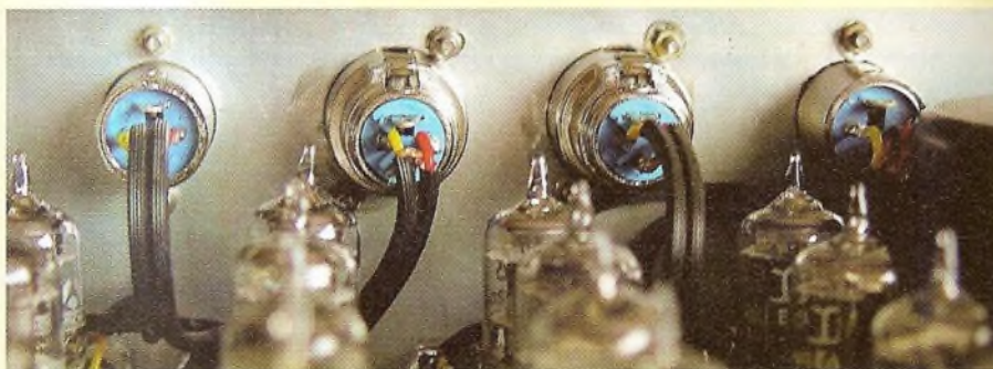
Photo B : Utilisation de prises XLR pour des entrées/sorties symétriques
