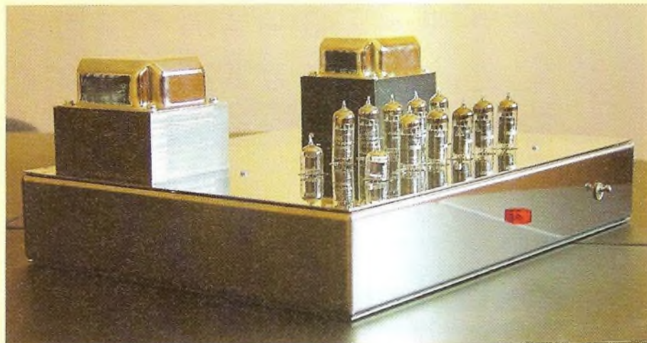
Photo D : L'amplificateur de 50 W monté sur un châssis Tub'Ox
