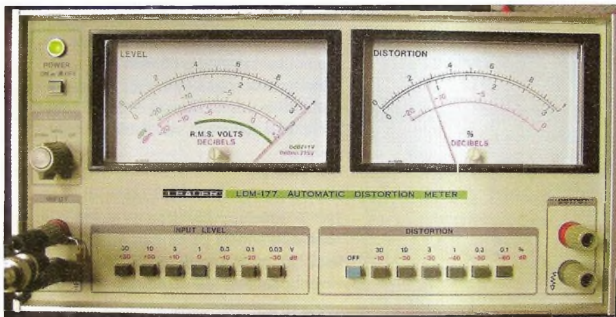
Photo L : Mesures DHT: 0,026 % à 1 Vac 1 kHz
