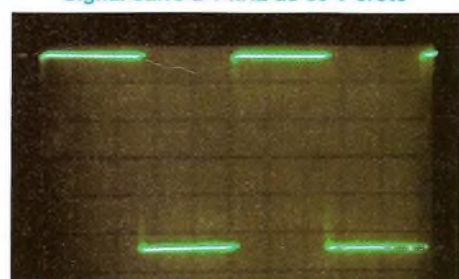
Signal carré à 10 kHz de 50 V crête
