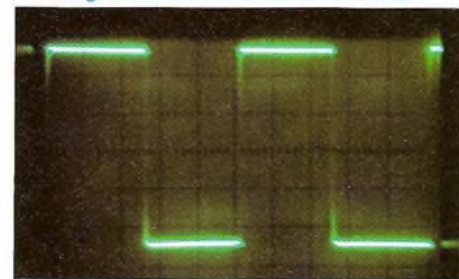
Signal carré à 1 kHz de 50 V crête
