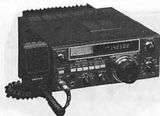
**FT 77.** Emetteur-récepteur mobile bandes décamétriques amateurs. 13.8V DC. 2 versions: 10/100W.
