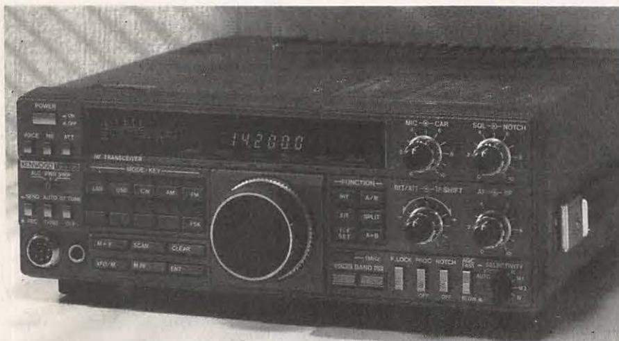
Le TR 751E est un transceiver 144 MHz fonctionnant dans tous les modes et prévu pour une utilisation en mobile ou en installation fixe. La puissance d'émission peut être choisie entre 5 et 25 W.
