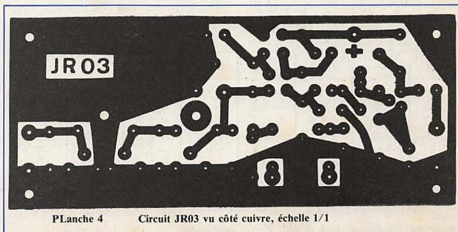
PLanche 4 Circuit JR03 vu côté cuivre, échelle 1/1
