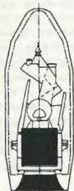
Coiffe ARIANE 2 INTELSAT V (F15) en configuration de lancement
