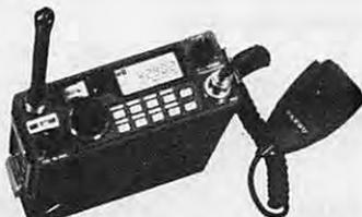
**YAESU - FT 757GX//.** Transceiver décimétrique nouvelle technologie, couverture générale de 500 kHz à 30 MHz en réception, émission bandes amateurs. Tous modes + entrée AFSK et Packet. 100 W. Alimentation 13,8 Vdc. Dimensions 238 x 93 x 238 mm, poids 4,5 kg. Option interface de télécommande pour Apple II ou RS 232C et cartouche MSX.
