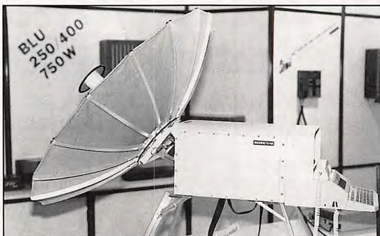
**Système de communication par satellite INMARSAT**
