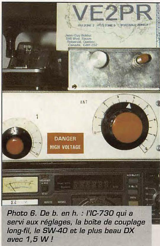
Photo 6. De b. en h. : l'IC-730 qui a servi aux réglages, la boîte de couplage long-fil, le SW-40 et le plus beau DX avec 1,5 W !
