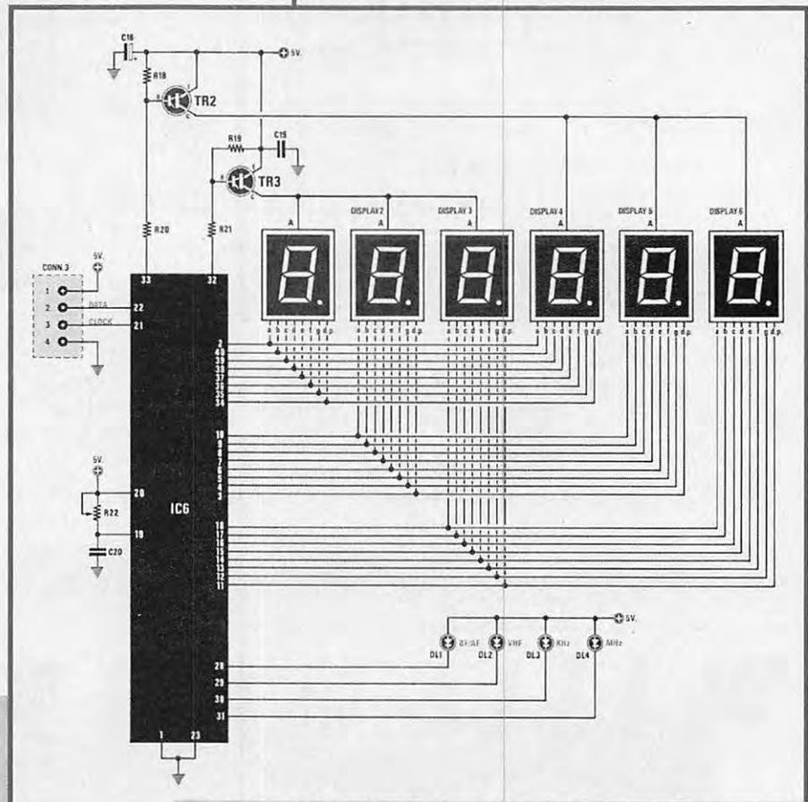
Figure 3. Schéma électronique de la commande d'affichage.
