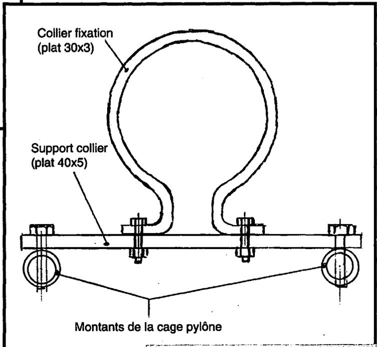
**Détail 2. Fixation du capteur.**
