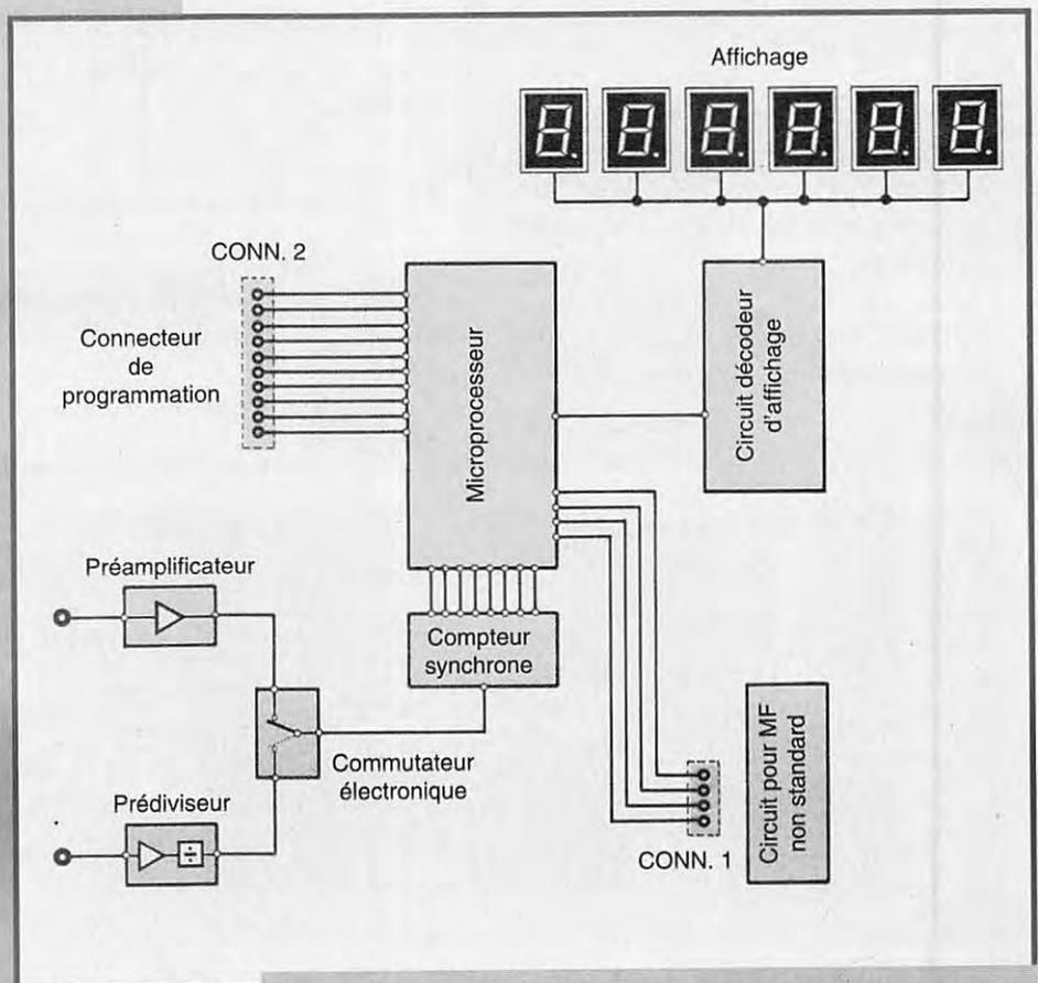
Figure 1. Schéma synoptique.
