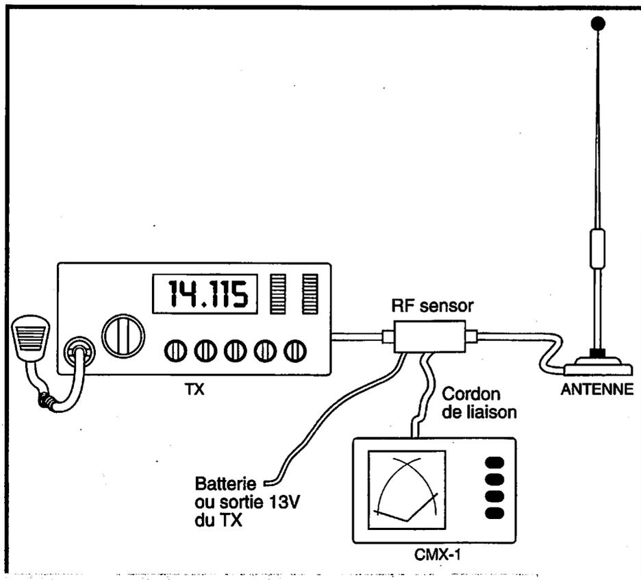
service de la station ! D'où l'usage possible en mobile ou en portable, dès lors que l'alimentation générale s'effectue à partir d'une batterie. Il est déconseillé de se servir du CMX avec une tension d'alimentation supérieure à 15 volts.
