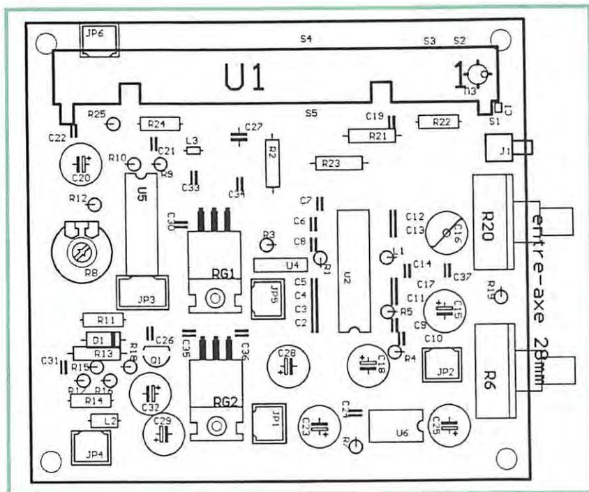
reconstitution de la composante continue. L'impédance de Q1 et de R18 permet d'obtenir environ 75 ohms avant le filtre de désaccentuation. Le condensateur C32 bloque la composante continue ; on perd légèrement le bénéfice du circuit de reconstitution mais la fréquence de coupure basse reste inférieure à 10 Hz.
