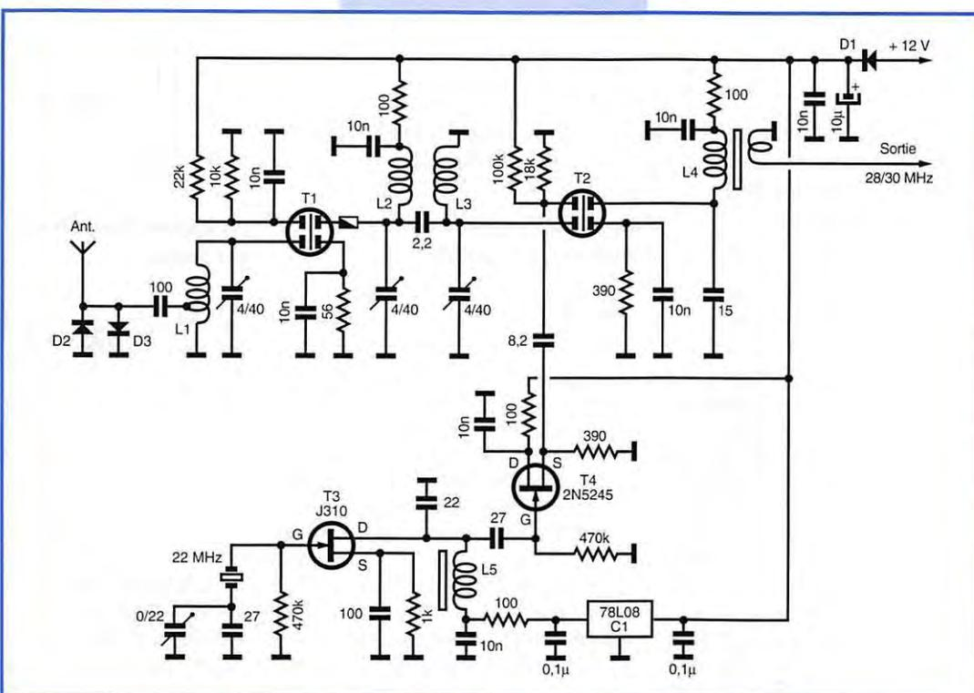
quence peut être ajustée précisément par le condensateur ajustable 0/22 pF. Si tel n'est pas le cas, il faudra changer la valeur du 27 pF mis en parallèle sur l'ajustable.
