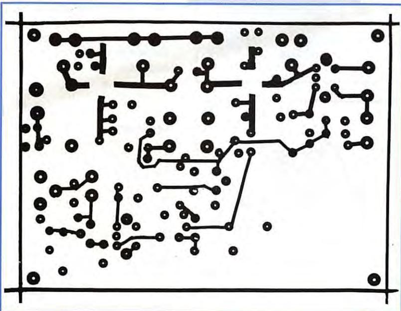
ment simple. Avec un transistor FET J310, le quartz de 22 MHz mis en place dans la gate de T3, oscille en fondamentale. La HF qui en est issue est mise en présence dans L5 après accord. T3
