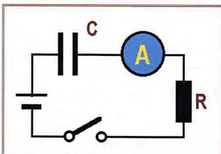
Si l'on construit un circuit tel que celui-ci, comportant une résistance, on peut constater à l'ouverture ou à la fermeture du circuit que l'ampèremètre dévie pendant un bref instant. Le condensateur se décharge ou se charge au travers de la résistance dont le rôle est de ralentir cette décharge ou cette charge.
