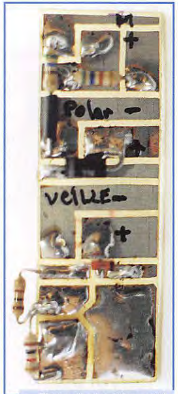
Platine de sécurité vue côté soudures et composants. Le thyristor n'est soudé que lorsque cette platine est mise en place.
