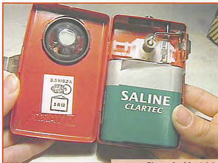
Photo 1 - Matériel nécessaire : une pile plate, une ampoule.
