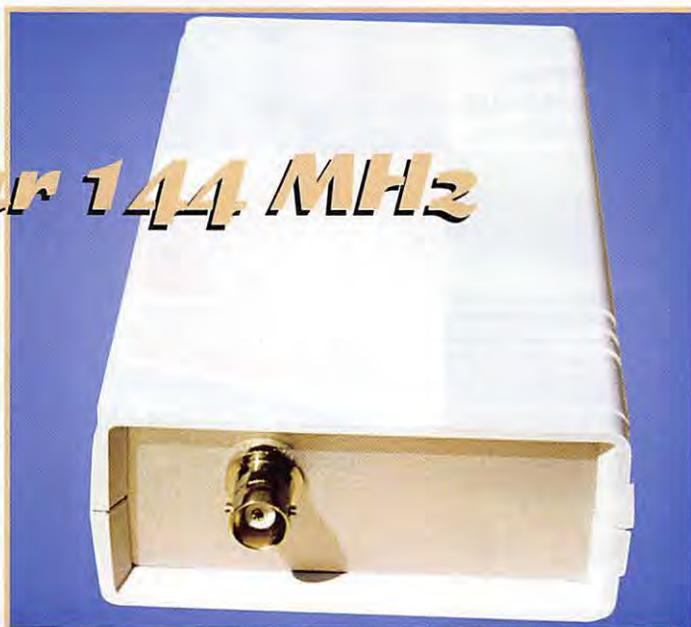
**Apprendre à réaliser un émetteur n'est pas chose difficile. L'exemple nous est donné ici avec ce kit Nuova Elettronica, émetteur 144 MHz FM piloté quartz délivrant 100 mW. C'est surtout un montage à vocation didactique...**
