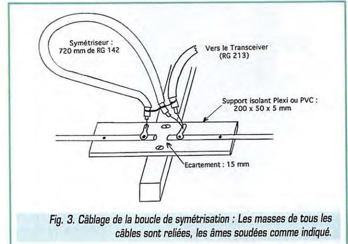
Fig. 3. Câblage de la boucle de symétrisation : Les masses de tous les câbles sont reliées, les âmes soudées comme indiqué.
