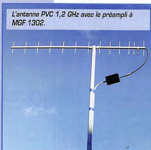
L'antenne PVC 1,2 GHz avec le préampli à MGF 1302.
