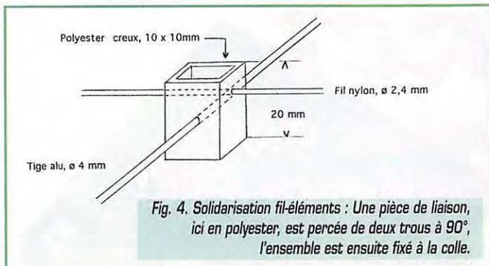
Fig. 4. Solidarisation fil-éléments : Une pièce de liaison, ici en polyester, est percée de deux trous à 90°, l'ensemble est ensuite fixé à la colle.
