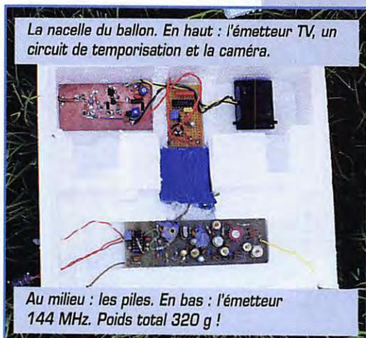
La nacelle du ballon. En haut : l'émetteur TV, un circuit de temporisation et la caméra.
