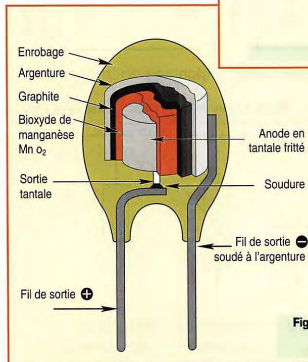
Figure 5 : Le condensateur au tantale à électrolyte solide (type « goutte »).
