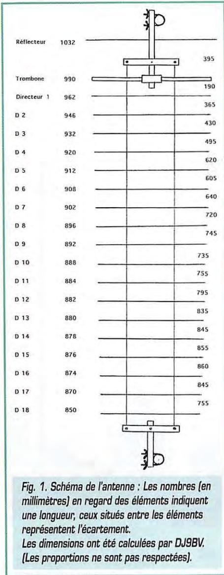
Fig. 1. Schéma de l'antenne : Les nombres (en millimètres) en regard des éléments indiquent une longueur, ceux situés entre les éléments représentent l'écartement. Les dimensions ont été calculées par DJ9BV. (Les proportions ne sont pas respectées.)
