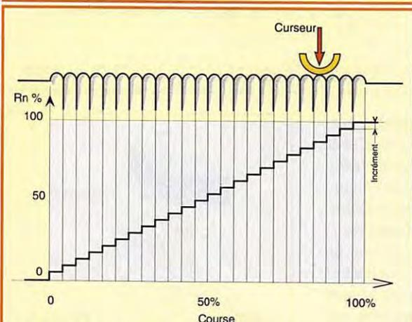
Figure 8 : La courbe de résolution d'une résistance bobinée.
