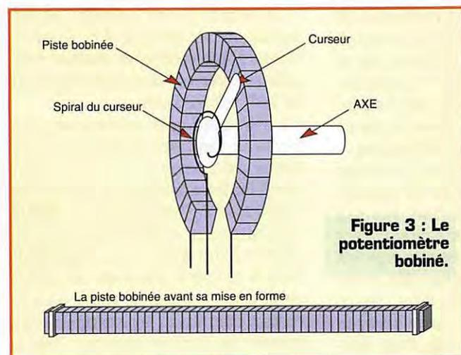
Figure 3 : Le potentiomètre bobiné.
