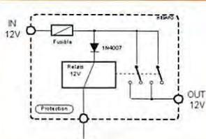
Figure 2 : Protection anti-inversions de polarité.
