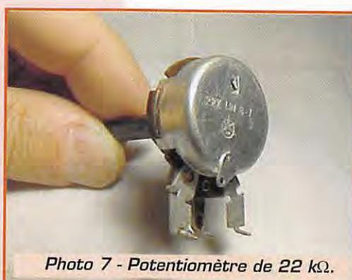
Photo 7 - Potentiomètre de 22 k $\Omega$ .
