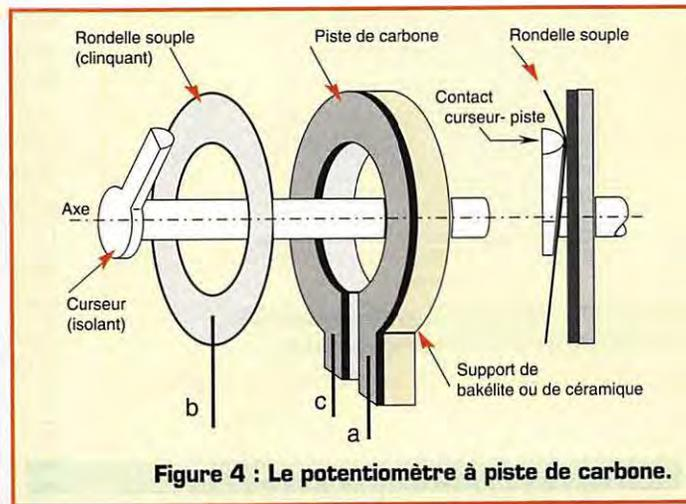
Figure 4 : Le potentiomètre à piste de carbone.
