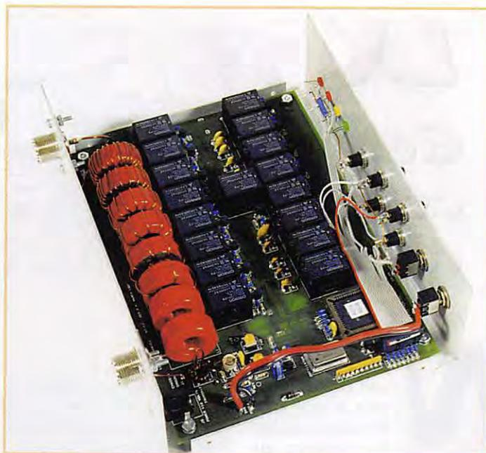
porter 150 W en respectant un rapport cyclique de 50 %. Je l'ai essayé avec succès sur un dipôle 80 m utilisé sur d'autres bandes, une antenne center feed avec balun FBCI à la base, une beam bandes hautes. Ce coupleur deviendra le compagnon idéal de votre station (QRP ou non).
