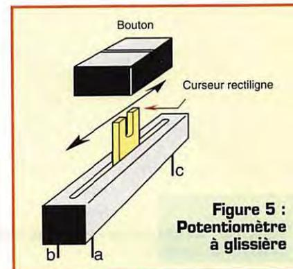
Figure 5 : Potentiomètre à glissière
