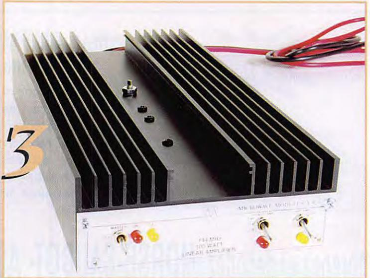
**S**i vous êtes à la recherche d'un amplificateur transistorisé, examinez le MML 144-100-3 présenté dans cet article. Que vous l'utilisiez en fixe, en portable ou en mobile, il vous permettra d'atteindre une centaine de watts avec seulement 3 W d'excitation. Compact, il est en fait « tout en longueur », d'où la possibilité de le loger sous un siège pour le mobile ou de le plaquer contre l'une des parois du coffre. Examinons-le plus en détail...
