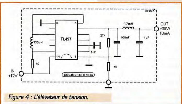
Figure 4 : L'élevateur de tension.
