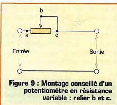
Figure 9 : Montage conseillé d'un potentiomètre en résistance variable : relier b et c.
