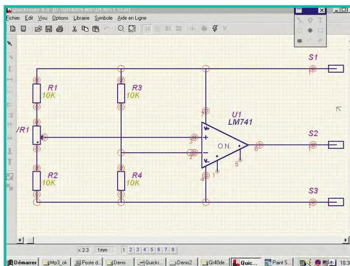
**Pour dessiner les circuits imprimés un peu complexes, il est préférable de s'aider maintenant de l'outil informatique. Il existe de nombreux logiciels : QUICKROUTE4 est l'un d'eux et présente plusieurs avantages parmi lesquels sa fonction de tracé de schémas, sa simulation de circuits, son routage automatique et sa relative simplicité de mise en œuvre.**
