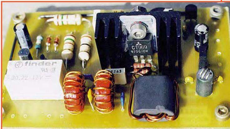
teur. On le branche simplement entre la sortie antenne et l'antenne, un "VOX HF" se chargeant de la commutation automatique émission-réception. Il peut également être intégré dans le même boîtier que l'émetteur-récepteur, ce qui est plus discret, à condition d'y trouver une petite place.
