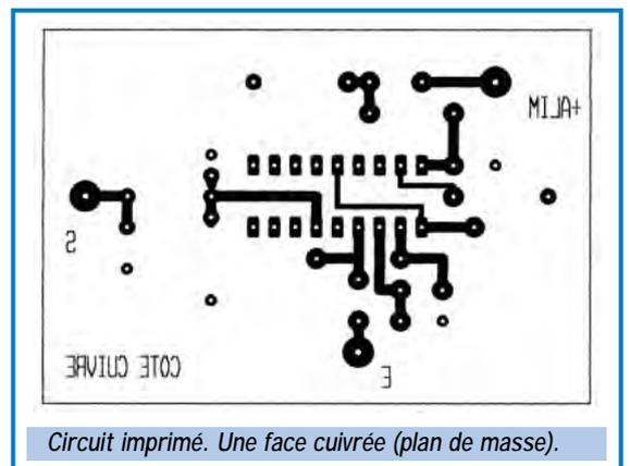
Circuit imprimé. Une face cuivrée (plan de masse).
