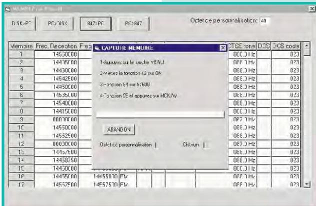
Une fois la zone chargée dans le tableau, chaque mémoire peut être éditée en cliquant sur le numéro correspondant. Les fréquences doivent être entrées en dizaines de Hertz, le shift correspond au shift programmé par
