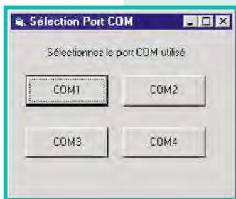
On sélectionne tout d'abord le port COM qui sera utilisé pour les transactions entre l'ordinateur et le 847. Nous verrons que celles-ci se déroulent à 57600b/s. Ensuite apparaît à l'écran un tableau vide qu'il va falloir remplir avec le contenu du transceiver. Ceci se fait par le bouton '847>PC'. Il suffit de suivre les instructions à l'écran.
