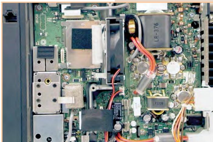
au 430 MHz, nous n'avons pu constater aucun défaut pendant les essais réalisés avec des stations locales ; la seule remarque que l'on puisse faire vaut pour tous les transceivers de cette catégorie et concerne l'affichage de la fréquence : nous avons mesuré 1 kHz d'écart entre la fréquence affichée et la fréquence réelle sur 70 cm, ce qui reste très acceptable pour 98 % des utilisateurs !
