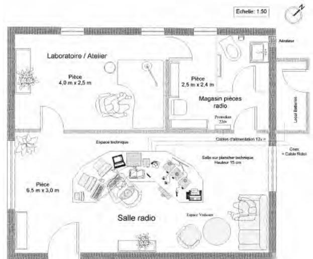
Concept architectural d'une station radioamateur.
