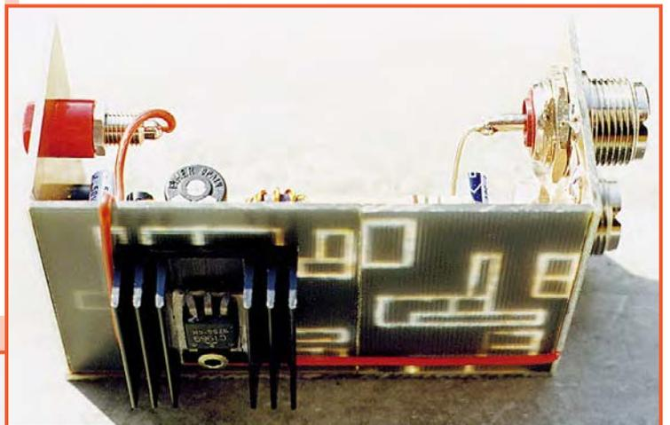
vérifiant que le relais utilisé est apte à passer une puissance HF plus élevée que celle d'origine). Le "plus" alimentation sera relié au "plus" émission. Là aussi, il faudra vérifier que le relais puisse passer plus d'un ampère en courant continu. Il est à noter que les relais préconisés dans mes précédents montages parus dans MEGAHERTZ magazine, conviennent parfaitement.
