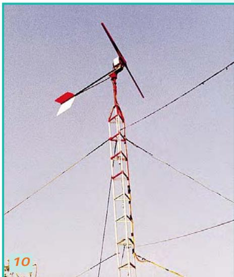
vent. L'hélice de 80 cm est connectée directement sur l'axe.
