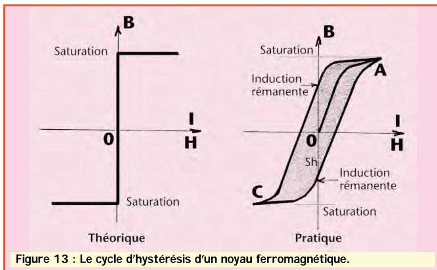
Figure 13 : Le cycle d'hystérésis d'un noyau ferromagnétique.
