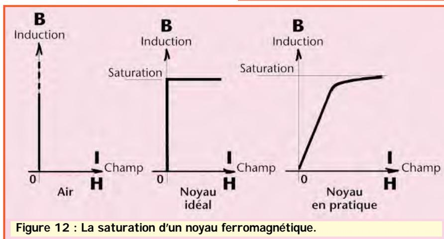
Figure 12 : La saturation d'un noyau ferromagnétique.
