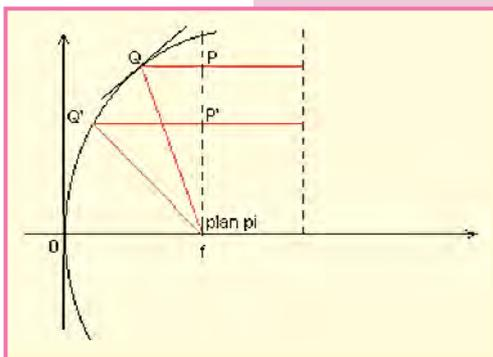
Un rayon perpendiculaire à ce plan pi et parallèle à la droite directrice se reflétera sur la parabole et le rayon réfléchi passera par le foyer f. Comme cette distance (PQ+Qf=P'Q'+Q'f) est constante pour tout rayon issu de P appartenant à pi, il n'y aura pas de déphasage en f. C'est la propriété qui nous intéresse le plus. Les rayons sont concentrés en f, d'où un gain important.
