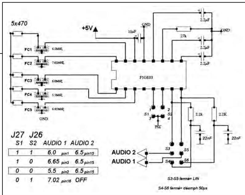
par C15. Vérifier avec la ligne 18 la coupure du filtre à 4,7 MHz... Le dernier burst à 5,2 MHz doit être inexistant. **NE PAS TOUCHER AU FILTRE F1.**
