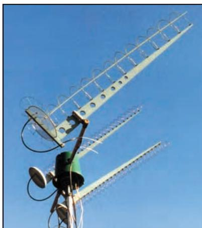
Particularité de la 430 MHz. La spire est faite avec un simple fil de terre domestique, un tamis de maçon est utilisé pour réflecteur.
