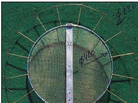
Réflécteur : Tamis inox de maçon + fil de brasure en laiton + laiton de 'sucre' + fil de cuivre en périphérie.
