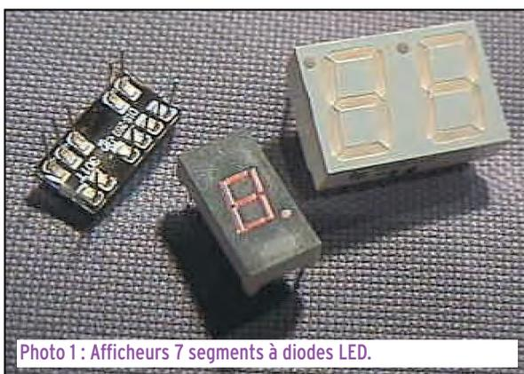
Photo 1 : Afficheurs 7 segments à diodes LED.
