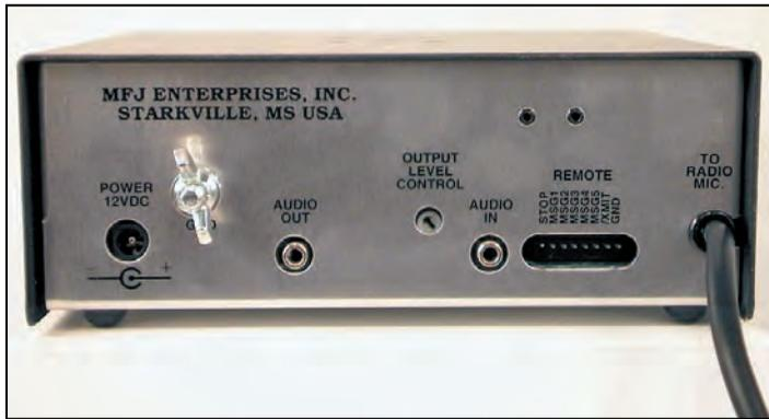
Sur la droite de la photo du panneau arrière, on aperçoit le connecteur pour la commande à distance.
