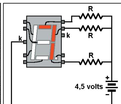
Figure 2 : Câblage d'un afficheur à cathode commune pour afficher le chiffre 7.
