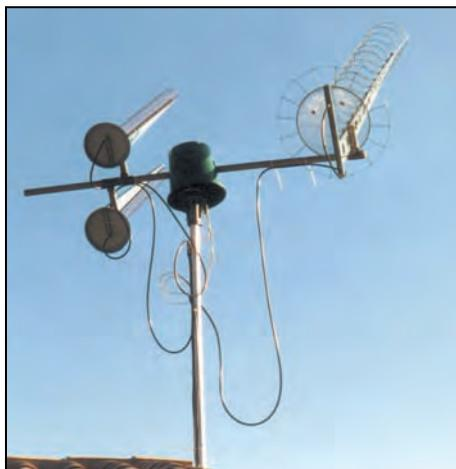
Une 430 MHz en test, faite dans le même esprit que les deux 1,2 GHz.
