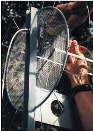
Montage de l'adaptateur d'impédance sur la 430 MHz.
