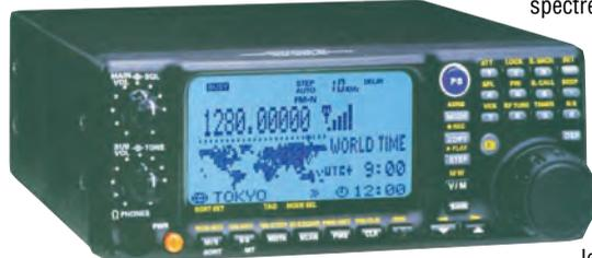
**VR-500F** Récepteur de 100 kHz à 1300 MHz. Modes AM/NFM/WFM/USB/LSB/CW. 1000 mémoires + 100 mémoires Pass + 10 mémoires de limite de recherche + 10 mémoires double veille + 1 mémoire prioritaire. Alimentation batterie 3 V ou adaptateur externe 9-16 Vdc. Dimensions : 95 x 58 x 30 mm hors projections. Poids : 220 g avec batterie et antenne.
