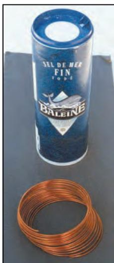
Du fil de cuivre, diamètre 1,2 mm, récupéré sur un vieux transfo mais, rien sous la main pour générer une spirale au diamètre approximatif de 76 mm pour réaliser une antenne « hélice » sur 1,2 GHz...
