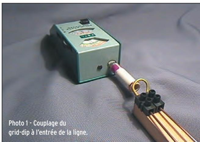
Photo 1 - Couplage du grid-dip à l'entrée de la ligne.
