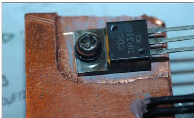
Figure 11 - Montage du TIP31.
