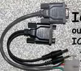
**IC-1** Câble (3 m) pour alimenter et piloter le Z-100 ou AT-100PRO depuis votre transceiver Icom IC706, IC-718, IC725, IC728, IC736, IC746, IC756, IC765...
