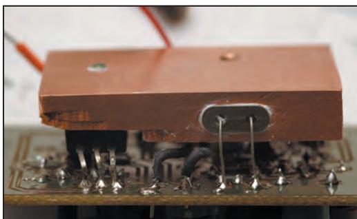
Figure 10 - Soudage des composants sur la semelle.
