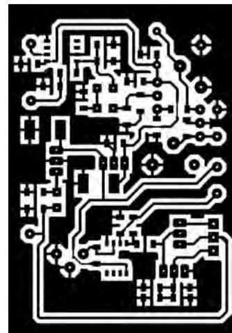
Figure 4 - Le circuit imprimé vu côté cuivre.
