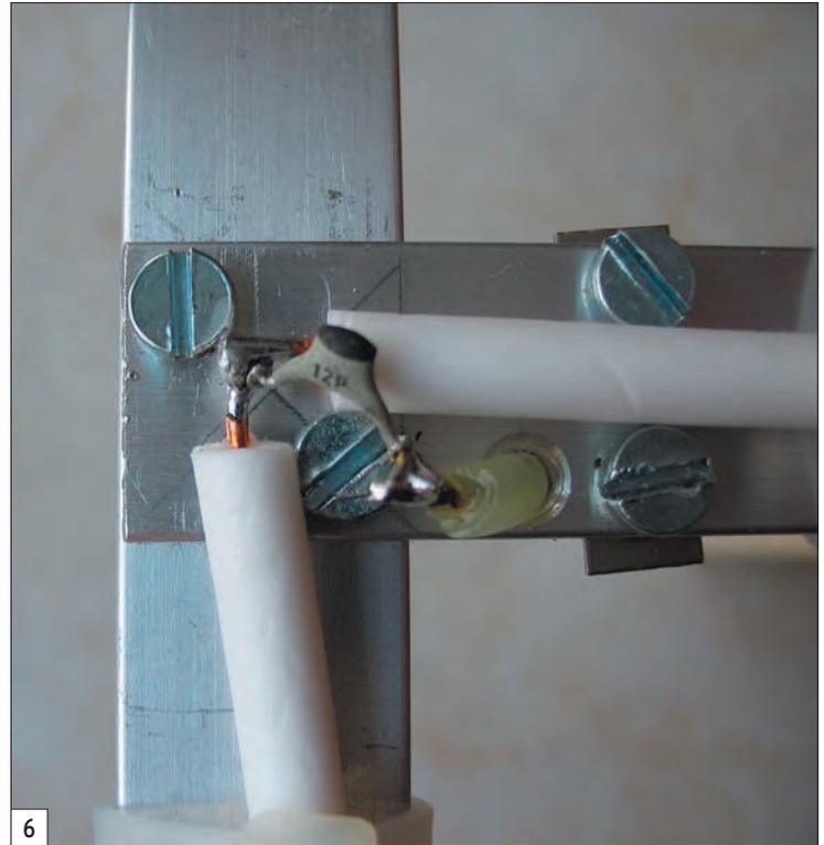
superposé, percer et visser. Vérifier l'équerrage puis percer les 2e trous et mettre la 2e vis qui bloquera le tout.
