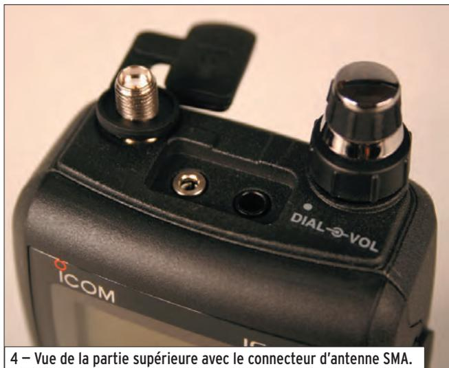
4 – Vue de la partie supérieure avec le connecteur d'antenne SMA.
