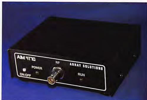
en utilisant un PC pour afficher les courbes et même l'abaque de Smith. Antennes, mais aussi filtres, câbles coaxiaux, quartz, etc. Comme l'angle de phase est mesuré, il n'y a aucune ambiguïté sur le signe de l'impédance, inductive ou capacitive. Piloté par un DDS, sa fréquence est rigoureusement stable et peut être recalibrée si nécessaire. L'AIM-4170 peut également servir de générateur HF. Pour en savoir plus sur ce produit (pas encore importé en France) visitez le site <http://w5big.com/> ◆
