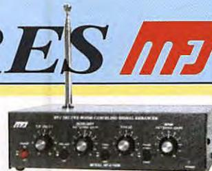
**MFJ 1026** Filtre éliminateur d'interférences réglable. Réglage amplitude et phase. Fonctionne dans la gamme HF pour tous les modes.
