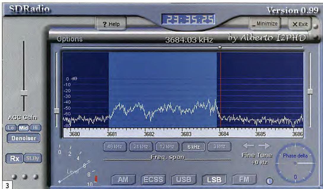
sant la molette du "mulot" ou les deux flèches "Fine Tune". La partie qui correspond à la bande passante du mode sélectionné apparaît en bleu clair sur l'écran, c'est elle que vous déplacerez sur l'émission à écouter. En réduisant sa largeur, vous réduisez d'autant la bande passante, c'est aussi simple que cela.
