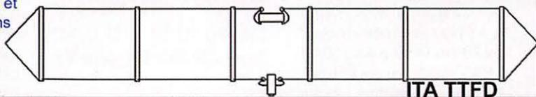
L'antenne **ITA TTFD** est un dipôle replié sur une résistance de charge non inductive. Elle fonctionne de 1,5 à 30 MHz en continu avec un ROS n'excédant pas 3:1 (1:1 avec boîte de couplage). La **ITA TTFD** est peu sensible aux parasites électriques et autres "bruits de fond". L'installation est possible à l'horizontale ou en "slopper". Fonctionne sans réglage, connecteur SO-239, longueur : 22 m et puissance max. : 800 W PEP.
