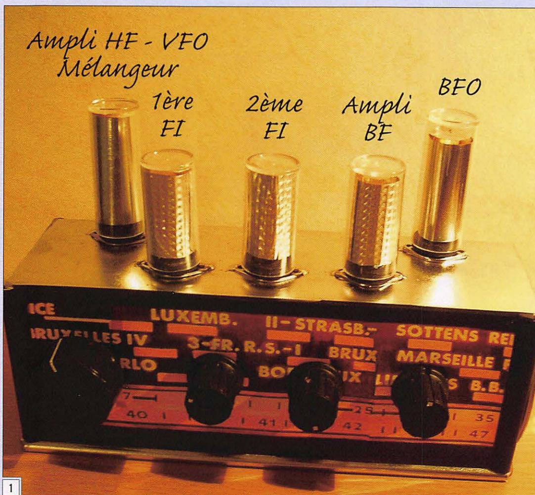
Les postes TSF à tubes présentent l'avantage de pouvoir suivre visuellement le "parcours" de nos ondes, de l'antenne au HP, en passant par les amplis FI et autres détecteurs spécifiques. À l'inverse, les récepteurs modernes apportent une telle intégration de fonctions dans un simple CI qu'il est bien difficile d'appréhender, pour un néophyte, le fonctionnement de ces appareils.
