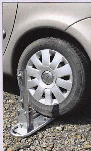
Quand on aime le trafic en portable, que ce soit en VHF ou en déca, on se pose souvent le problème du support de mât : comment faire pour une mise en oeuvre rapide et une fixation fiable. Une des réponses consiste à utiliser un support se glissant sous une roue du véhicule, quand ce dernier est sur place. Ce support, dont la partie verticale se rabat vers le sol (articulation) permet donc de monter le mât en toute sécurité et de le basculer ensuite à la verticale. Le MCB3
