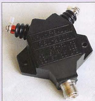
Acceptant une puissance pouvant aller jusqu'à 2 kW PEP, ce balun 1/1 est prévu pour une utilisation entre 0,5 et 60 MHz. Il est équipé de deux cosses pour recevoir les brins d'une antenne filaire (ou pour relier par fils un dipôle en tubes d'aluminium) et doté d'un connecteur type SO-239.
