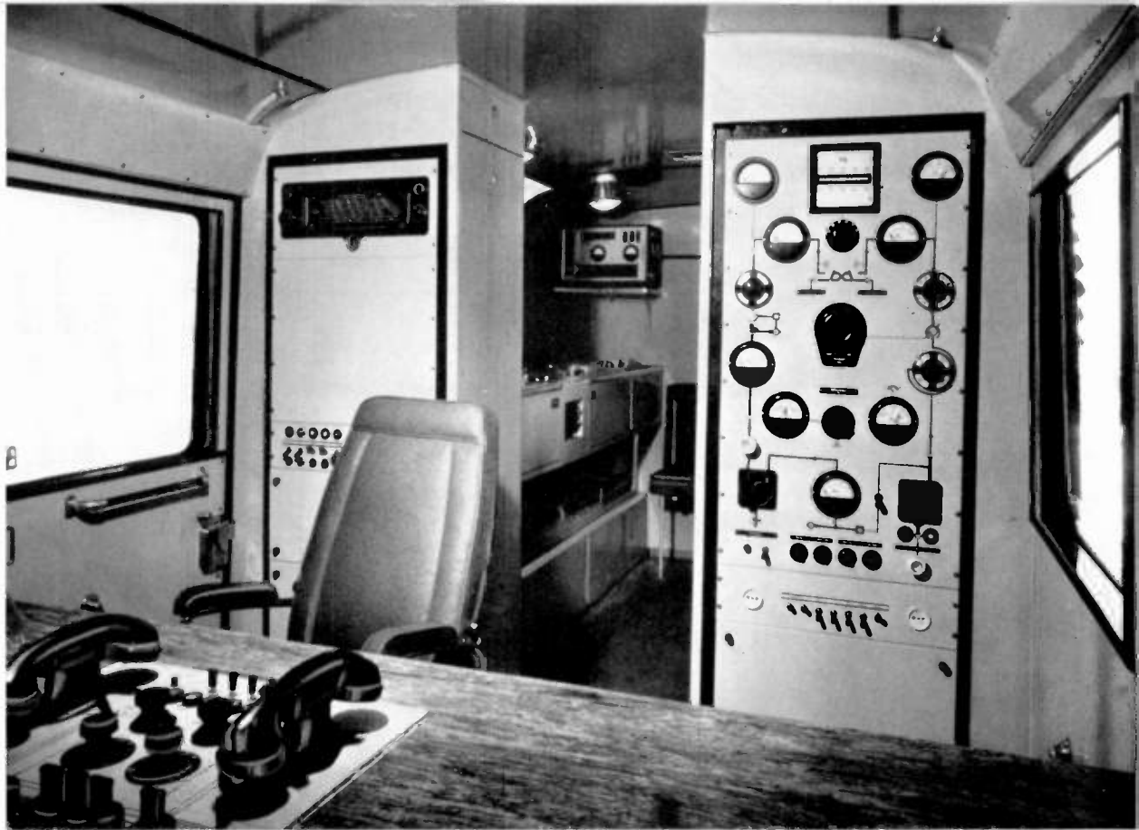
Regietisch in einem Übertragungswagen. Im Hintergrund die eingebauten Tonbandgeräte.
