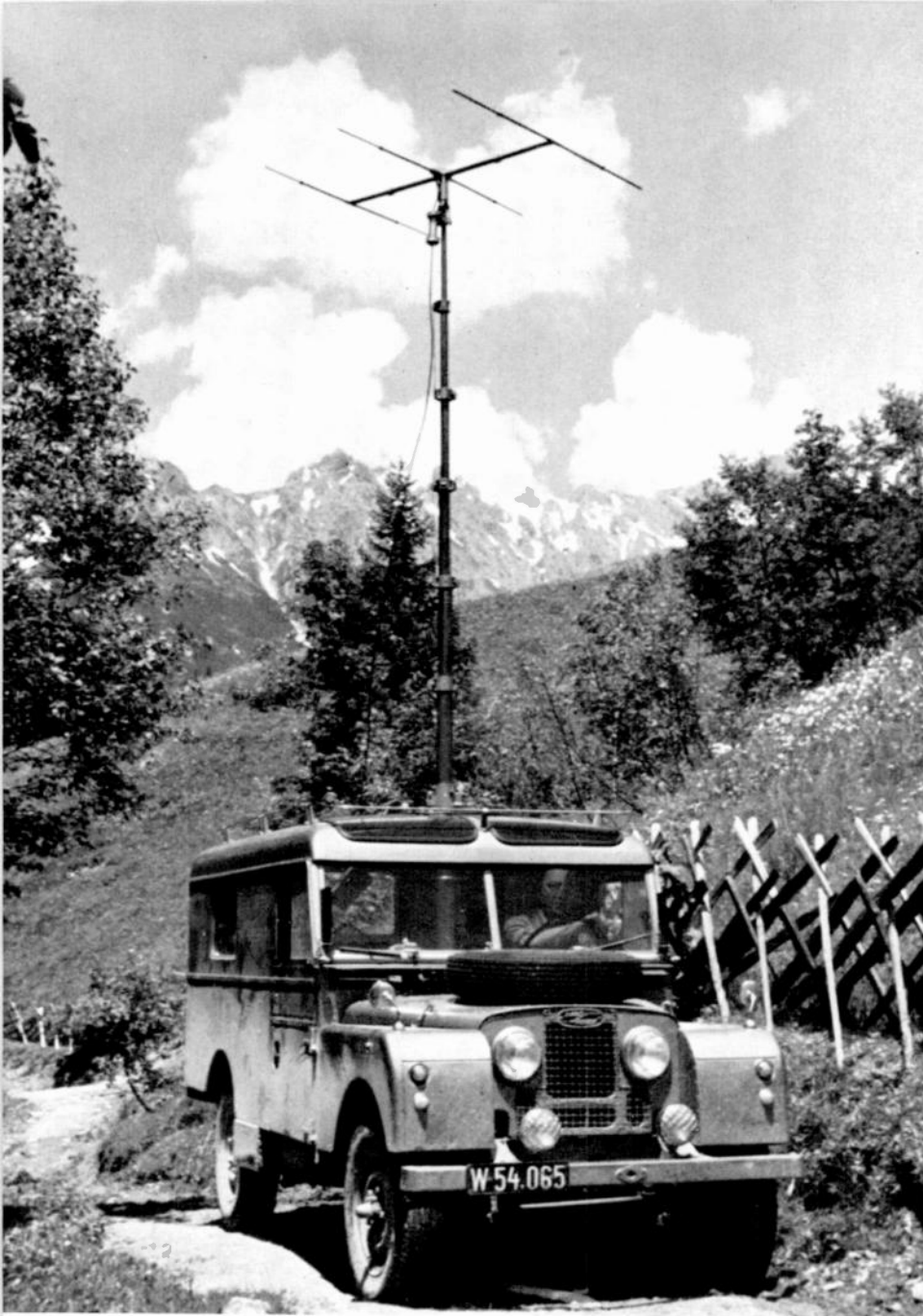
Für Planung und Kontrolle von Sendestationen sind zahlreiche Messungen im Gelände notwendig. — Ein Meßwagen im Hochköniggebiet.
