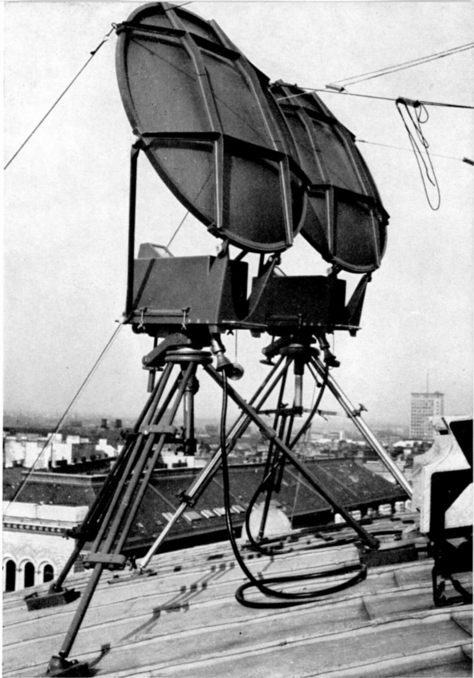
Richtfunkgeräte auf dem Dach des Wiener Burgtheaters übertragen die von den Kameras aufgenommenen Fernsehbilder zum Sender Kahlenberg.
