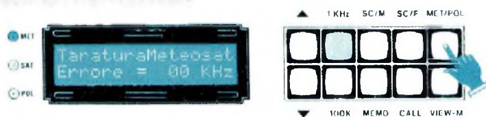
Fig.41 Apparaît l'inscription "Taratura Méteosat - Errore 00 KHz" ôter les 52 KHz en trop.
