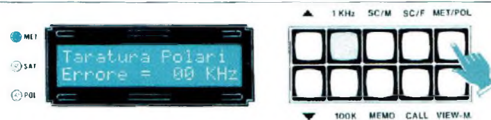
Fig.31 En appuyant à nouveau sur la touche MET/POL, l'inscription "Taratura Meteosat - Errore 00 KHz" est visible sur l'afficheur.(décalage affichage Meteosat)
