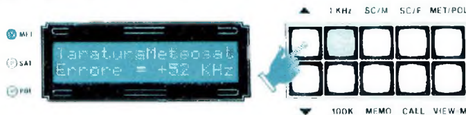
Fig.42 Appuyer sur la touche P1 jusqu'à faire apparaître "+52 KHz", c'est à dire les Kilobertz en excès, puis appuyer sur la touche MET/POL
