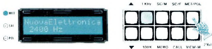
Fig.39 Eteindre le récepteur puis le mettre à nouveau sous tension en gardant appuyée la touche MET/POL de façon qu'apparaisse 2.400 Hz environ.
