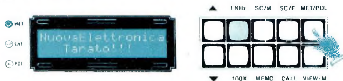
Fig.40 Appuyer de nouveau sur MET/POL et après l'affichage de l'inscription "Tarato" appuyer de nouveau sur cette touche.
