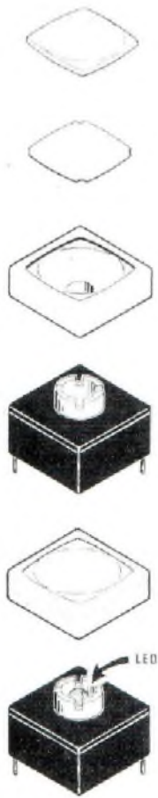
Fig.23 Les boutons-poussoirs visibles en Fig.20-21 sont composés de quatre parties. Cinq d'entre eux comportent une LED à l'intérieur.
