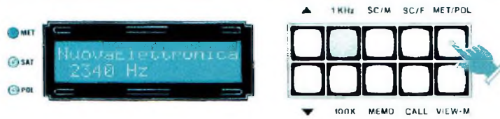
Fig.28 Pour le réglage sur 2.400 Hz maintenir appuyé le bouton-poussoir MET/POL et mettre sous tension l'appareil.
