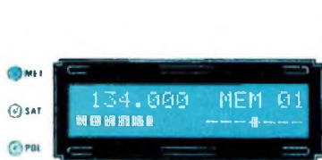
Fig.37 Eteindre le récepteur. A la remise sous tension, même si le récepteur n'est pas parfaitement accordé, le curseur de l'AFC se porte au centre en corrigeant automatiquement la fréquence de l'accord.
