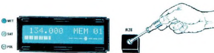
Fig.35 Tourner l'ajustable R28 à mi-course puis le noyau de la MF3 jusqu'à porter la curseur de l'AFC au centre de l'échelle.
