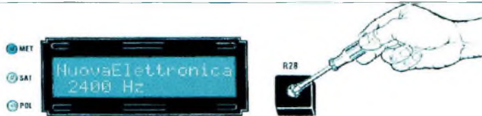
Fig.28 Pour le réglage sur 2.400 Hz maintenir appuyé le bouton-poussoir MET/POL et mettre sous tension l'appareil.
