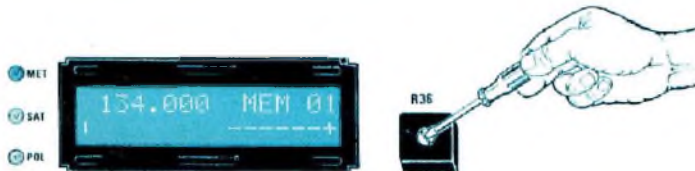
Fig.36 En absence de signal Météosat, tourner l'ajustable R36 jusqu'à faire apparaître sur le S-Mètre un seul élément.
