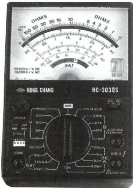
Le multimètre «analogique» comporte un cadran à aiguille mobile. Une sensibilité de 20k \Omega /V est un minimum pour ce type d'appareil.
