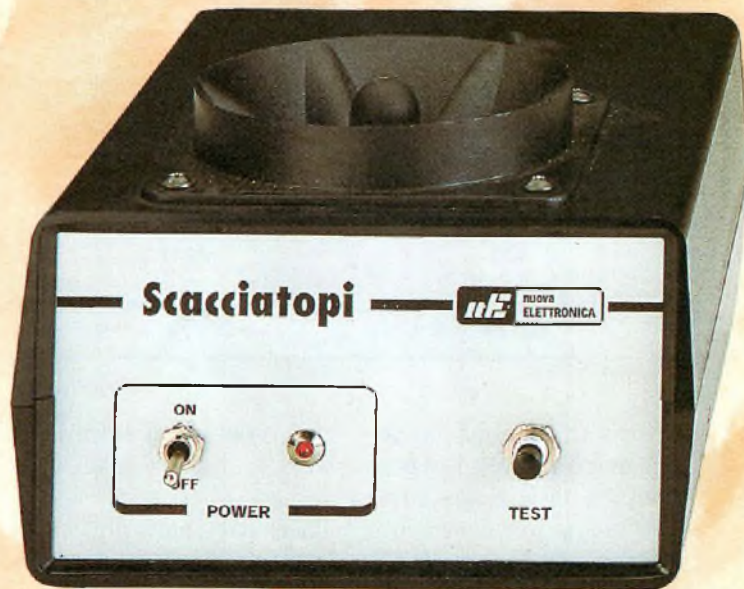
Fig.1 Le Tweeter de puissance est placé sur le couvercle du boîtier plastique.
