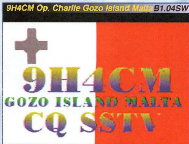
Fig.4 Image de 9H4CM qui de l'île de Malte a fait CQ SSTV sur 14 230 MHz. En présence de QRM, les photos captées comportent des lignes altérées par le bruit.
