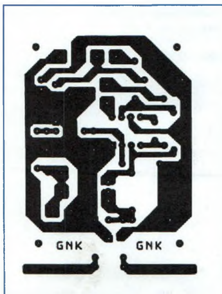
Fig.2 Circuit imprimé vu côté cuivre reproduit à l'échelle 1.
