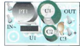
Fig.7 Schéma d'implantation de l'alimentation 12 volts MK175A12
