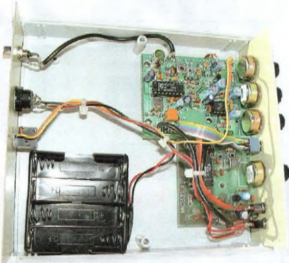
Fig.3 Le BFO est monté sur un petit circuit additionnel, en bas à droite.
