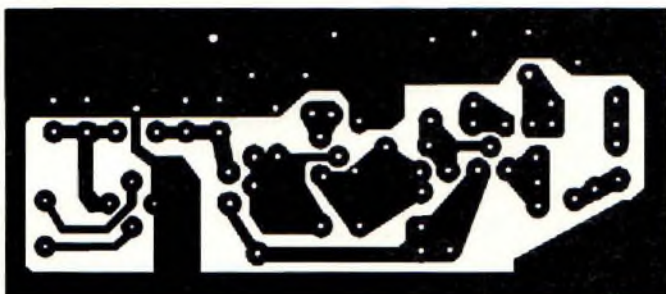
Fig.2 Reproduction à l'échelle 1 du circuit imprimé vu du côté cuivre.
