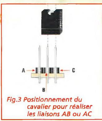
Fig.3 Positionnement du cavalier pour réaliser les liaisons AB ou AC
