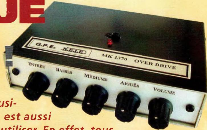
*Cette boîte à distorsion aux caractéristiques musicales exceptionnelles est aussi simple à réaliser qu'à utiliser. En effet, tous les composants (pile comprise) prennent place sur un circuit imprimé aux dimensions réduites (10,5 x 7,5 cm). Elle est dotée des contrôles de distorsion, tonalités (basses, médiums, hautes), volume en mesure de satisfaire même les plus exigeants des guitaristes.*
