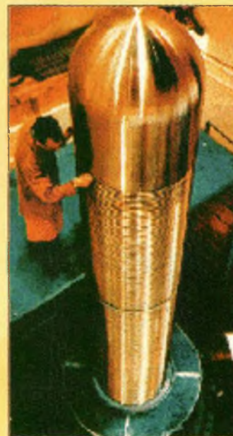
Les générateurs électrostatiques actuels utilisent toujours les principes définis au 18 ème siècle. Ici un générateur électrostatique Van de Graaff.
