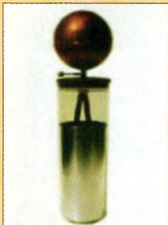
La bouteille de LEYDE inventée par Pieter Musschenbroek permet de stocker des charges électriques. Elle est composée d'un récipient métallique contenant de l'eau suspendu par des liens de soie. Un connecteur de cuivre plongé dans le liquide centre traverse un bouchon de liège qui ferme le récipient.
